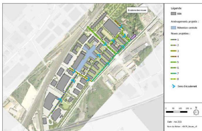
Réseau de noues de collecte des eaux de ruissellement pluvial
